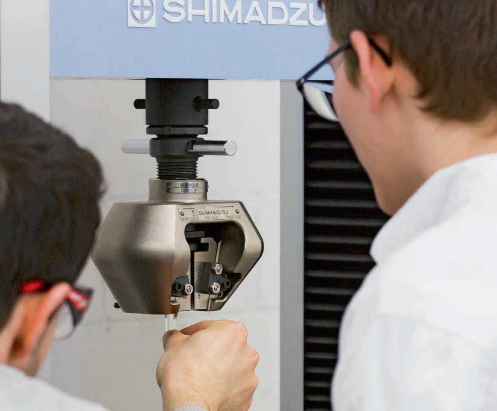
Sprödes Material, zähes Material? Mit der Zugprüfmaschine werden Festigkeitskennwerte ermittelt.
