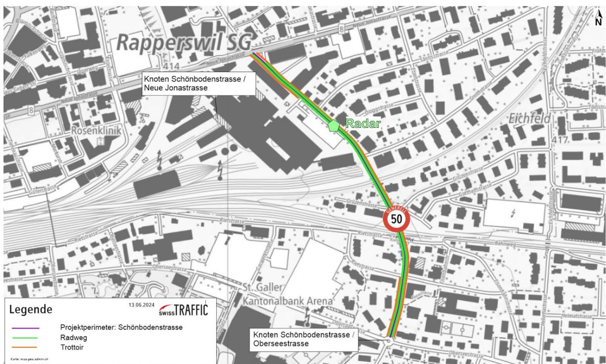
*Standorte der Verkehrserhebung mittels Seitenradar*
