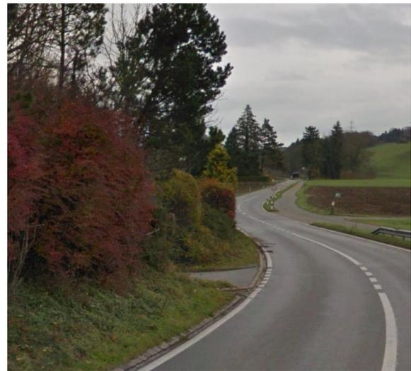
*Deutlich verringerte Fahrbahnbreite ohne Berücksichtigung der punktuellen Verbreiterungen / eingeschränkte Sichtverhältnisse in der Nähe des Beginns der Geschwindigkeitslimit von 60 km/h*
