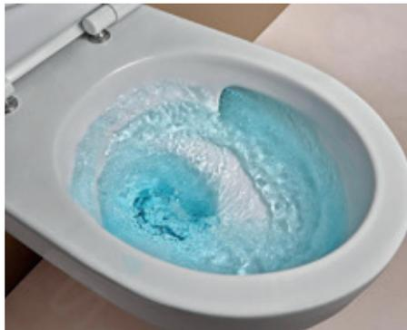
Mit der TurboFlush-Technologie stellte Geberit die nächste Generation der Spültechnik vor. Bei der sogenannten Drehspülung wird das Wasser seitlich so in die Toilettenschüssel geleitet, dass ein Wirbel erzeugt wird. Dies sorgt für eine besonders gründliche, leise und wassersparende Spülung und Reinigung der WC-Keramik.
