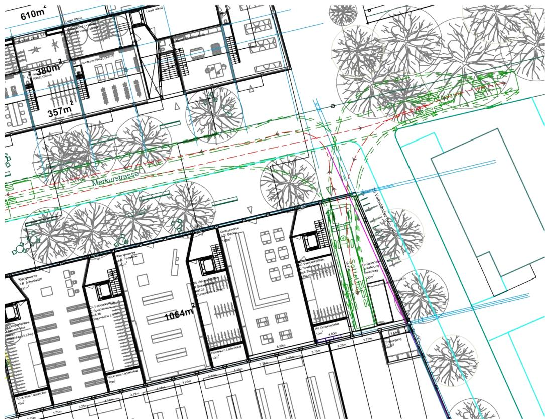
*Fahrmanöver Sattelschlepper via Merkurstrasse mit ins Gebäude integriertem Lkw-Standplatz*
